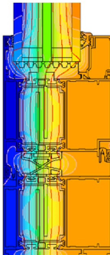
Voorbeeld van de isothermenverdeling voor de verbinding van het kader en het deurvleugelprofiel van het systeem GN 75 (GN414 + GN425)
